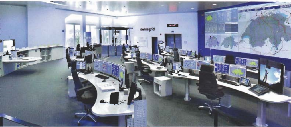
Die große Cube-Wand besteht aus 5 x 3 DLP-Doppellampensystemen aus dem DLP-Portfolio von Barco und weist eine Bildfläche von 700 x 315 cm bzw. 5.120 x 2.304 Pixel auf.
