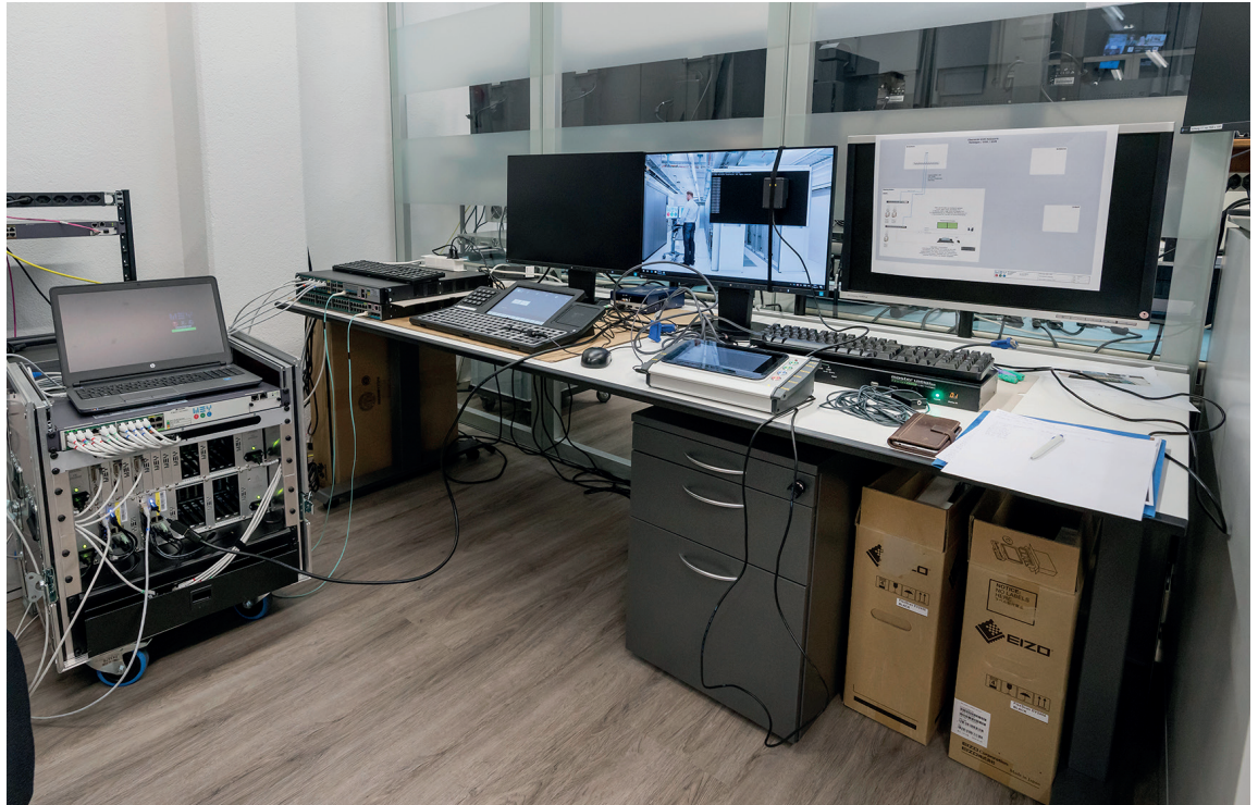
Abb. 1: Test-/Messaufbau einer IP-basierenden KVMA-Matrix-Absetzung eines Leitstellenarbeitsplatzes
